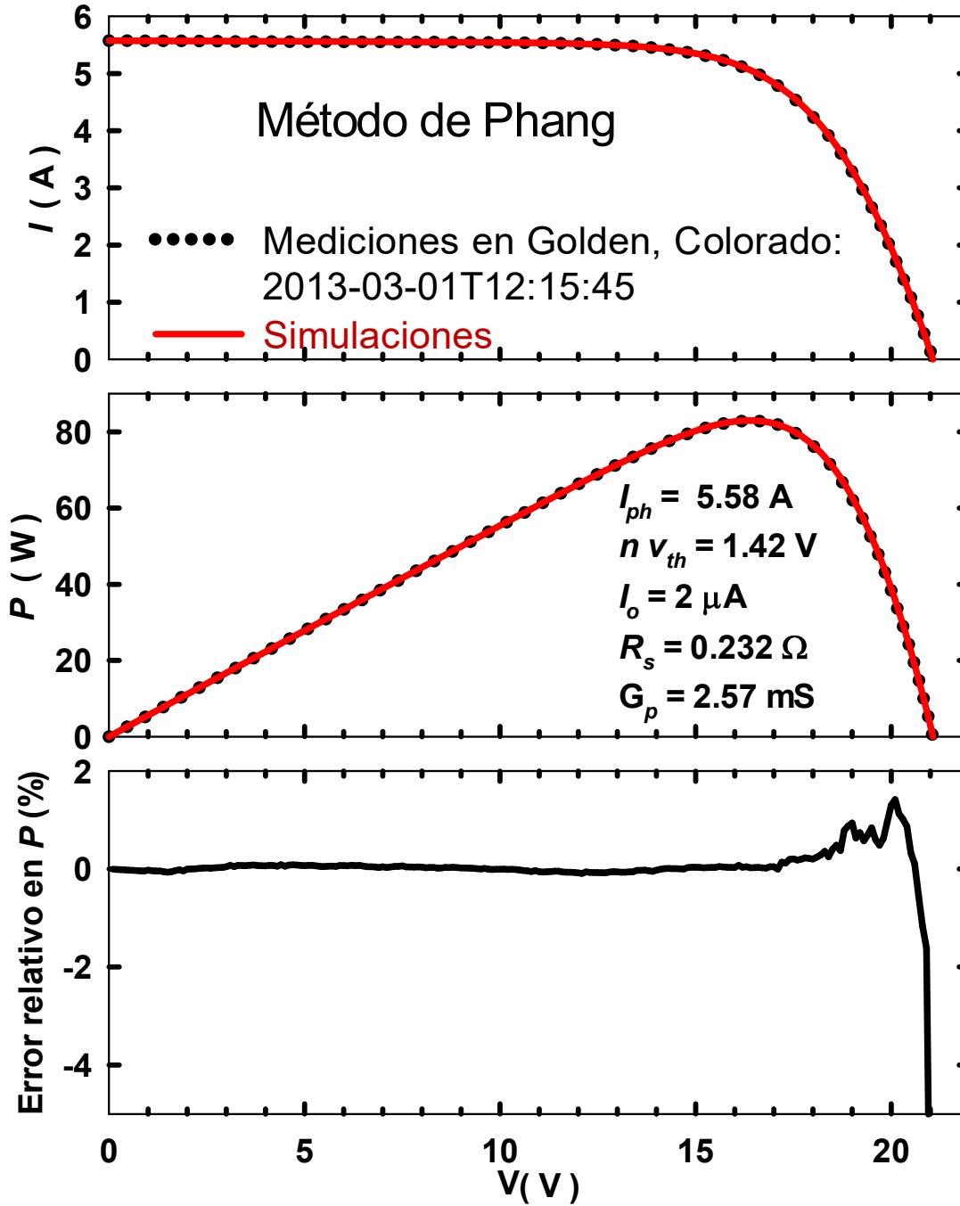
El ruido en las mediciones dificulta la obtención de las derivadas. Debemos usar “fitting” de rectas para derivar.
